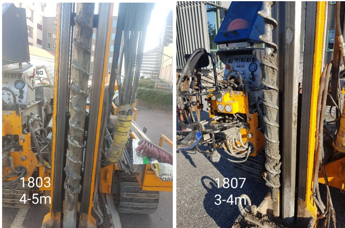
Figur 9. Foton som visar vad som i fält bedömdes vara naturligt avsatt material i form av lera till vänster i bild samt sand och silt till höger.
