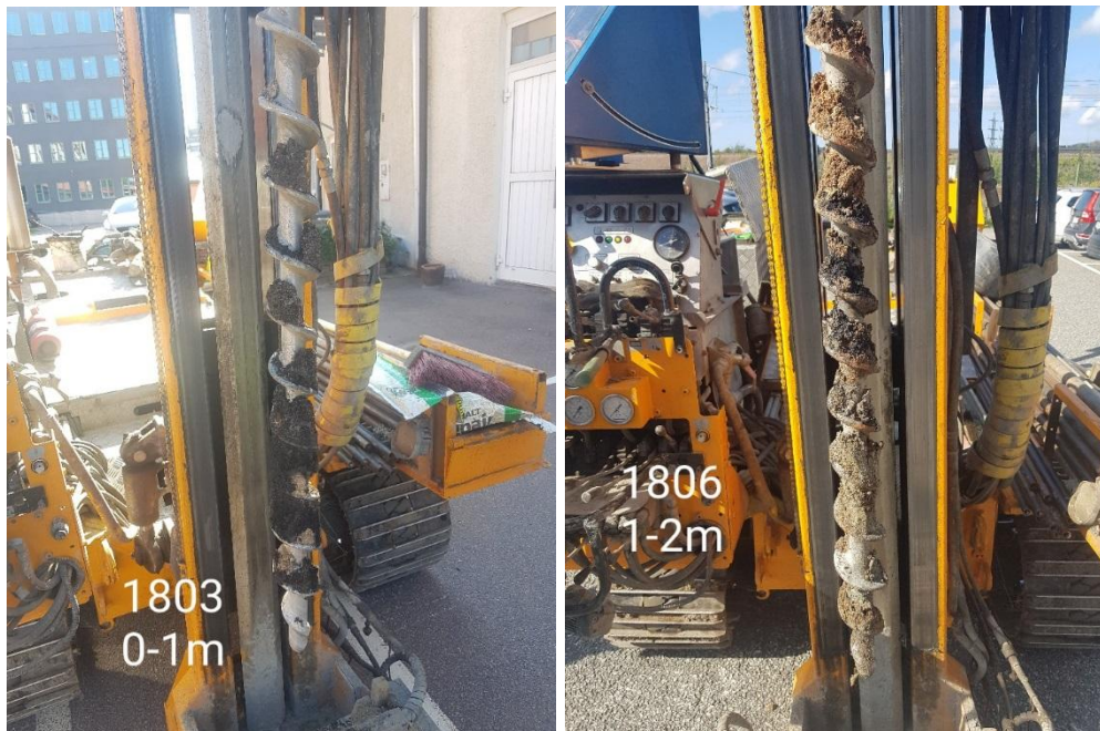
Figur 8. Foton som visar fyllnadsmaterial innehållande sand och silt med inslag av tegel och slaggliknande produkt från två av skruvborrpunkterna.
